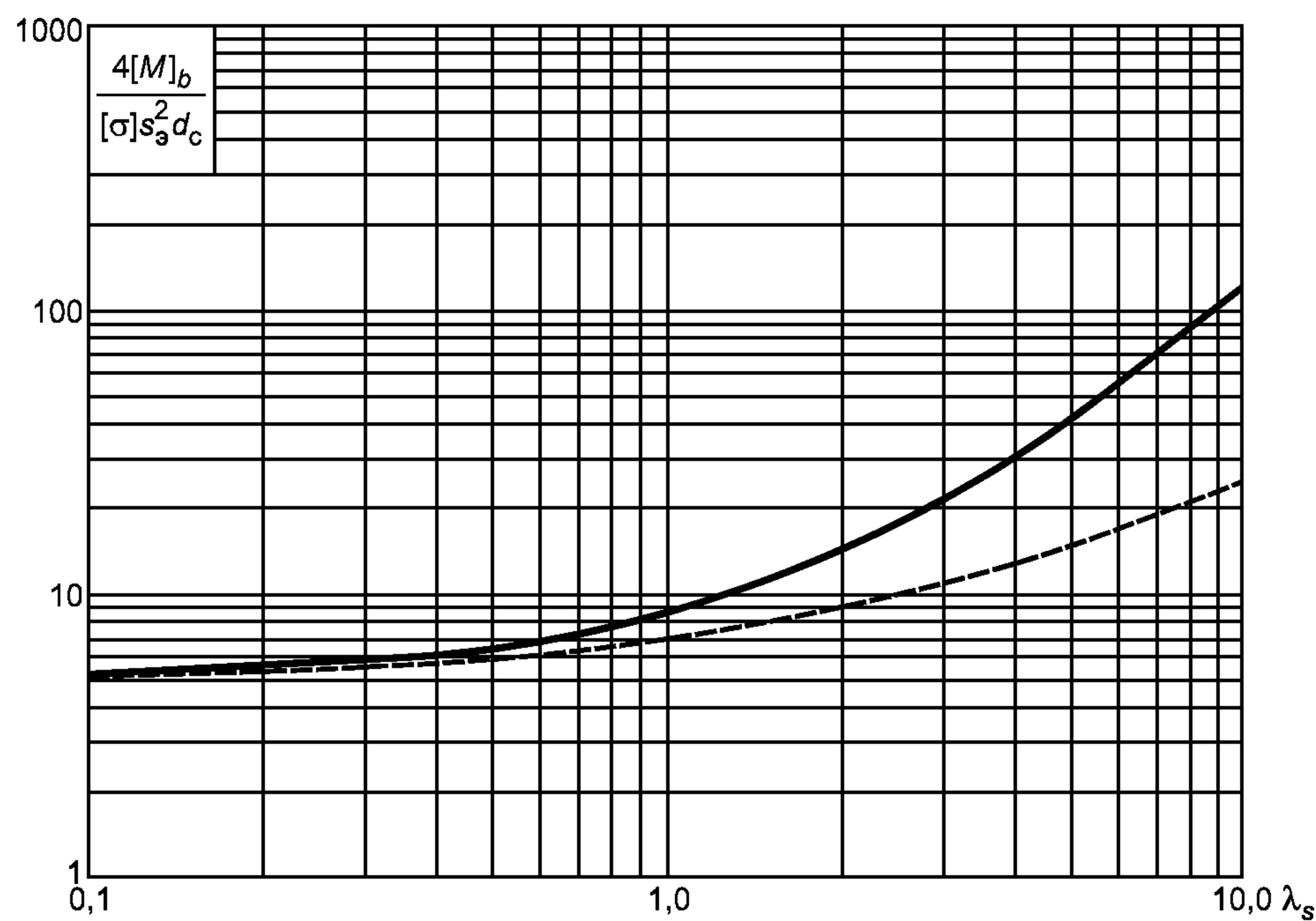
Рисунок А.20 — График для определения  $[M_b]$
