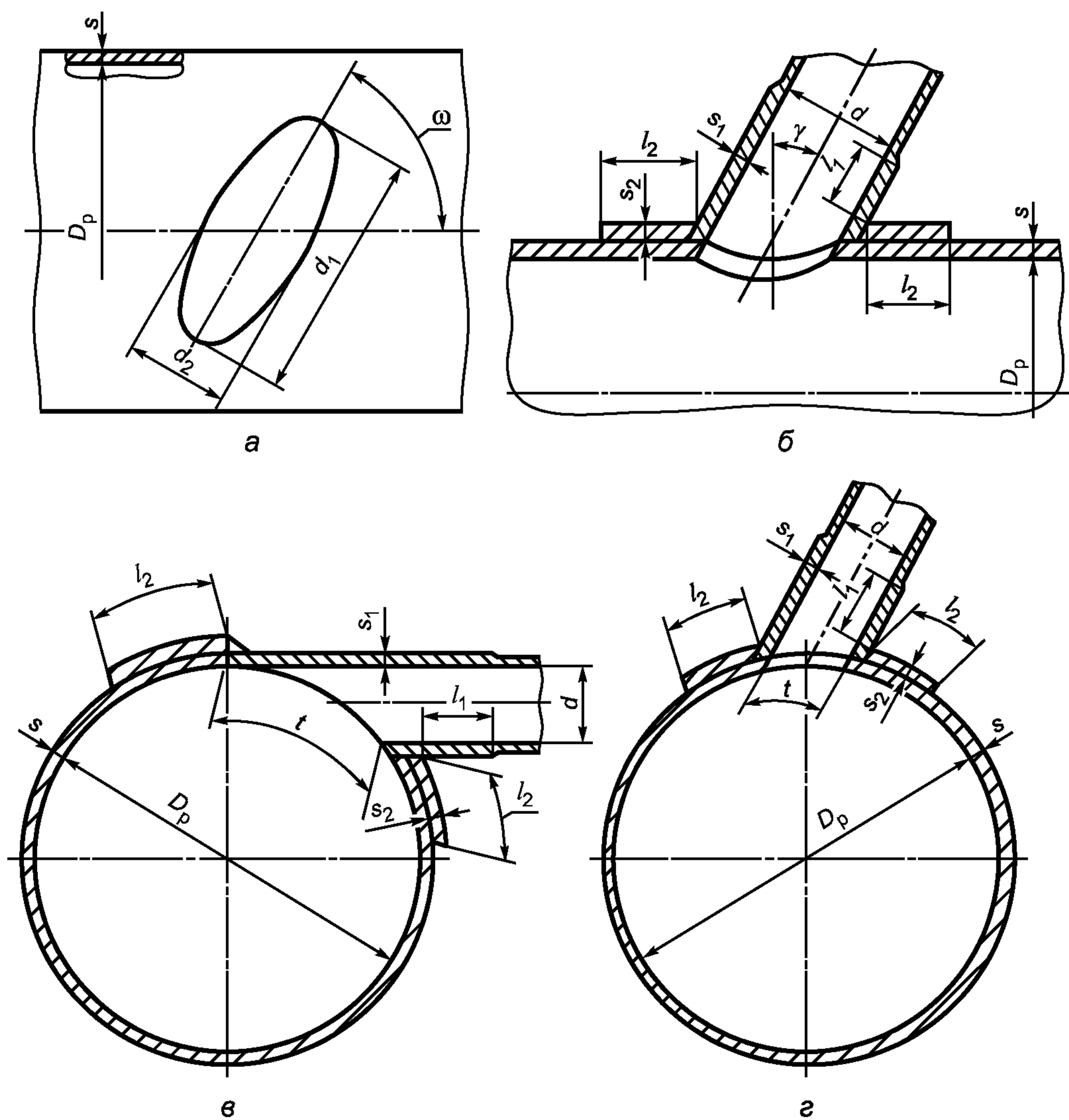
Рисунок А.11— Наклонные штуцера на обечайке
