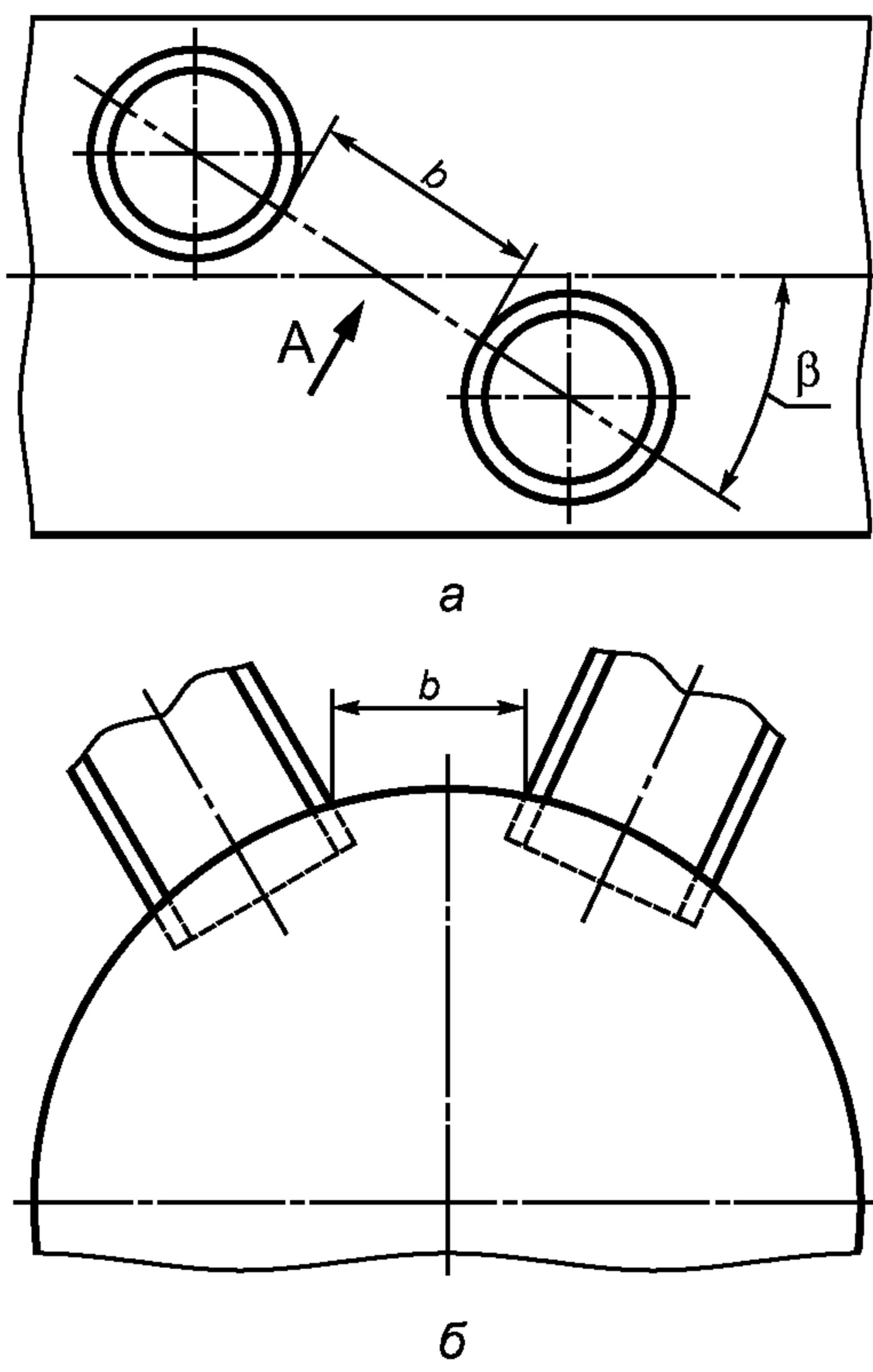
Рисунок А.3 — Общий случай расположения взаимовлияющих отверстий
