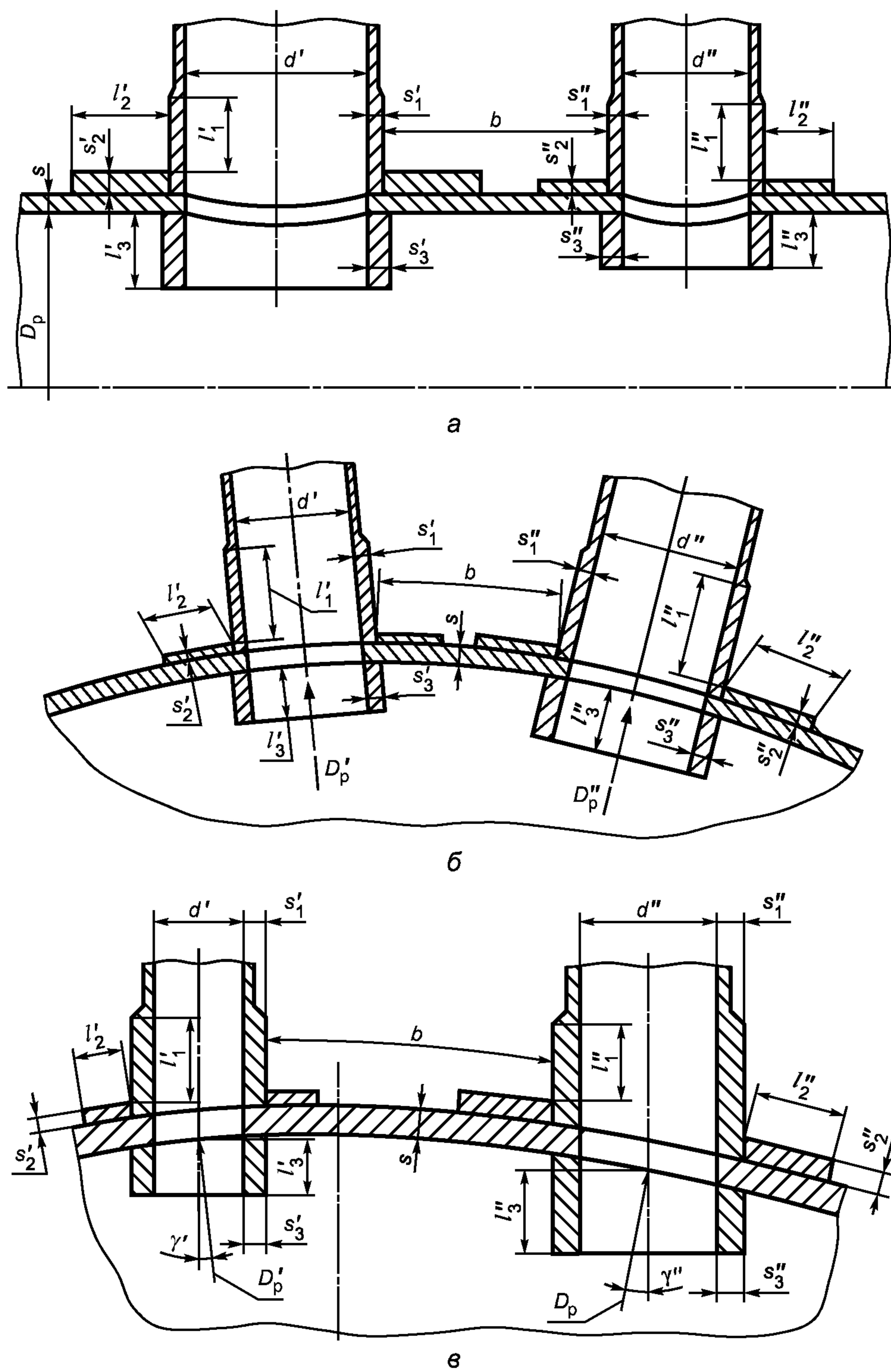
Рисунок А.2 — Укрепление взаимовлияющих отверстий
