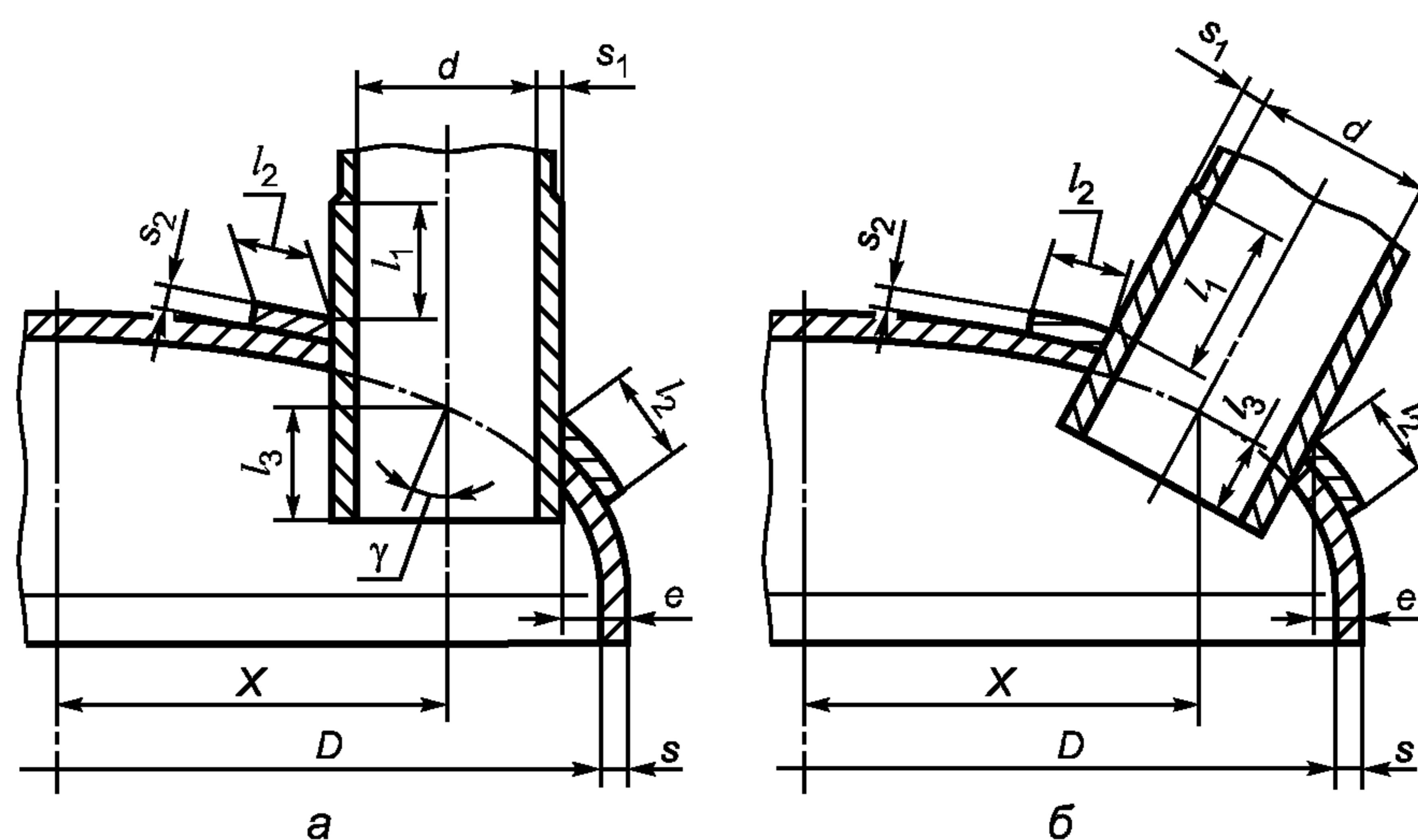
Рисунок А.5 — Смещенные штуцера на выпуклом днище
