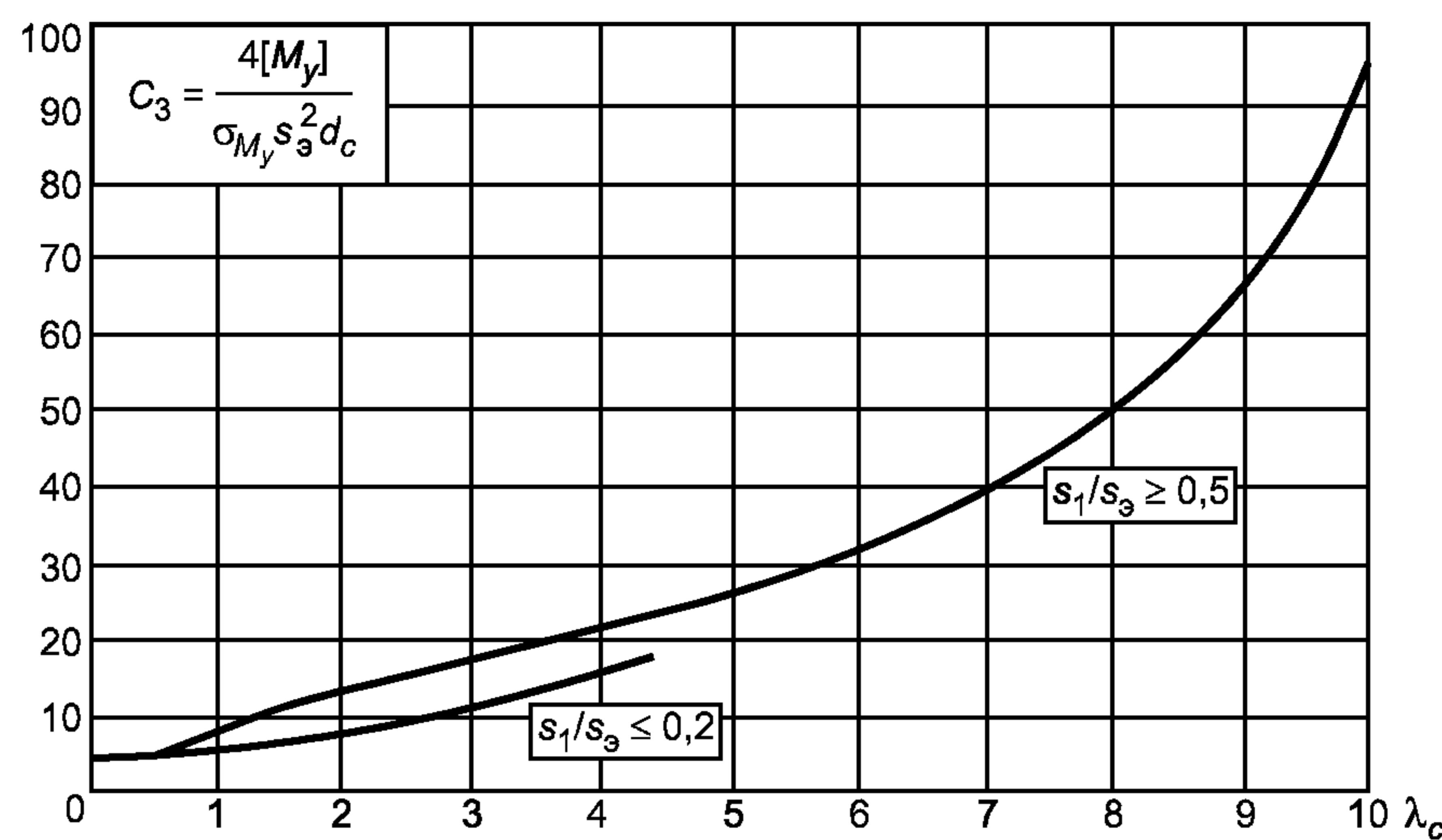
Рисунок А.18 — График для определения  $C_3$
