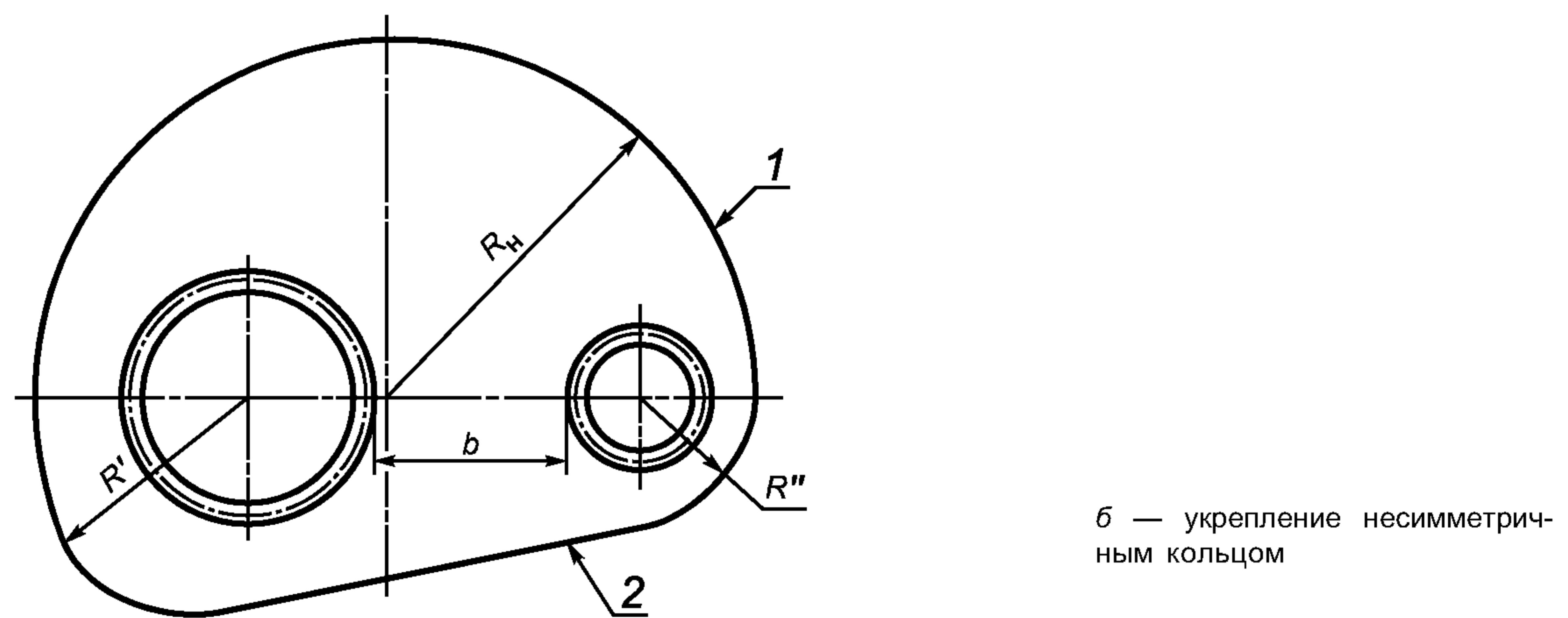
Рисунок А.8 — Совместное укрепление взаимовлияющих отверстий
