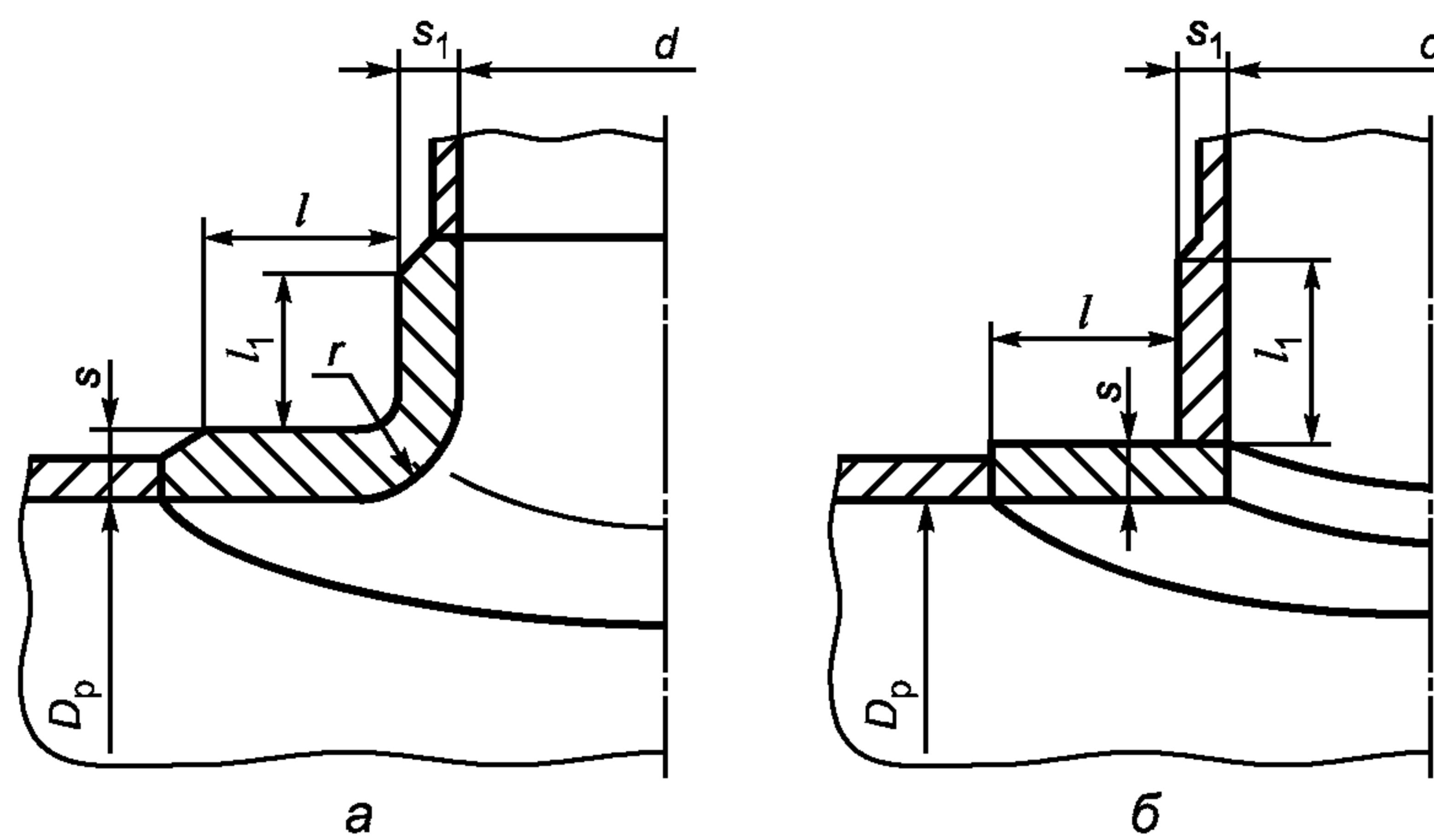
Рисунок А.10 — Укрепление отверстия торообразной вставкой или вварным кольцом
